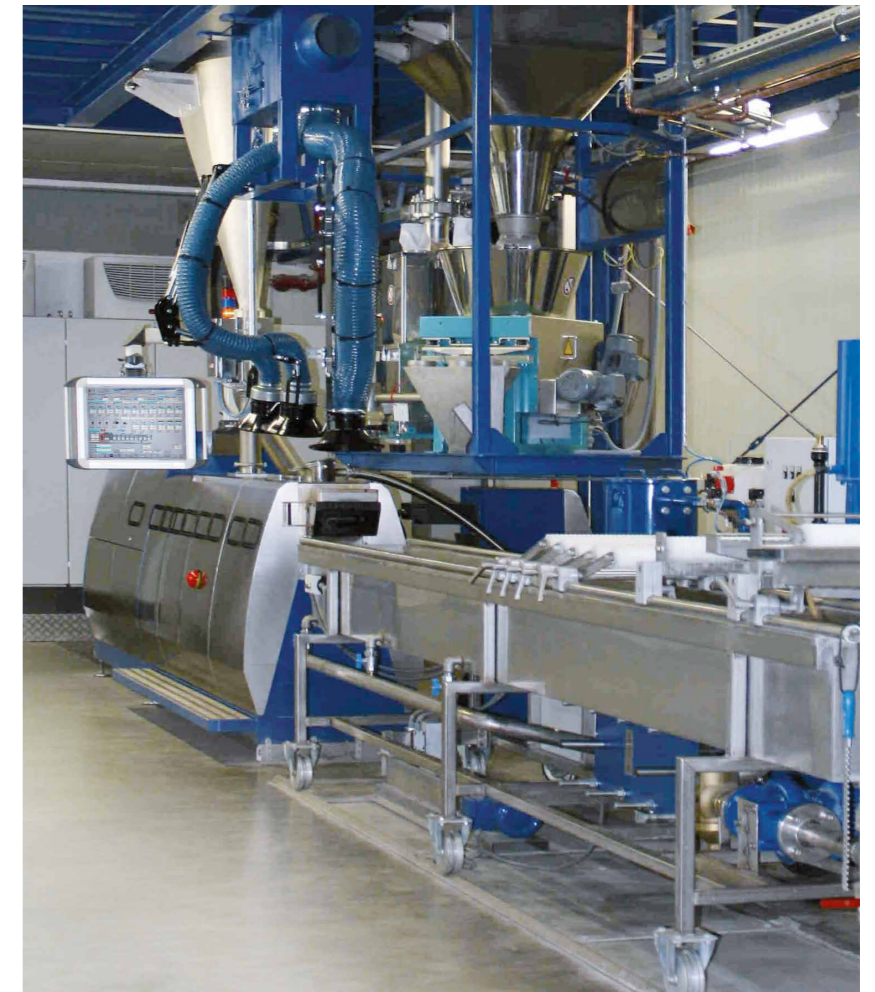
Extrusionslinie mit flexibler Verfahrenslänge und wahlweise Strang- oder Unterwassergranulierung.
