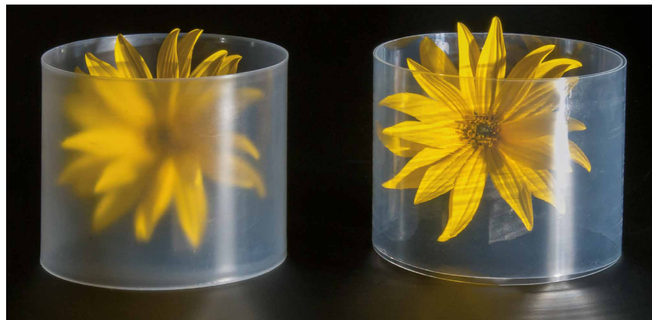
Maximale Transparenz in PP durch optimal auf Extrusions- oder Spritzgussprozess angepasste Clarifierkonzentrate.
