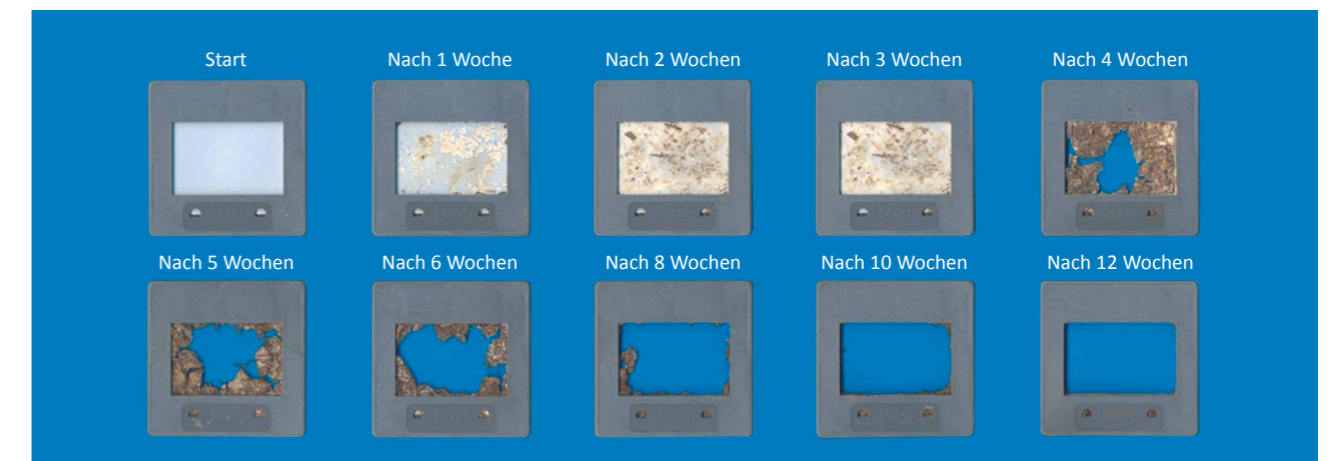
Eine Studie des Instituts „Organic Waste Systems“ in Belgien zeigt, dass eine Plastiktüte aus M-VERA® B5010 mit einer Wanddicke von 288 µm innerhalb von 12 Wochen vollständig durch Bakterien zersetzt wird.
